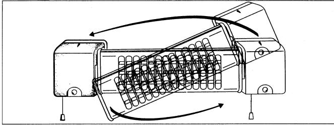
Má-li obslužný díl být na levé straně, je třeba spínač opatrně šroubovákem vyzdvihnout otočením o 180° z držících svorek a vsadit do obou volných svorek. Dávat přitom pozor na to, aby spínač dobře zapadl.
