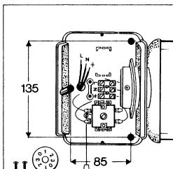
Díry vyvrťte a přístroj upevněte na zeď přiloženými hmoždinkami a šrouby.
