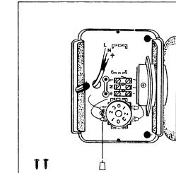
Víko obslužného dílu (C) s okénkem (B) nasadte přes červené spínací kolečko a upevněte oběma šrouby.
