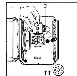
Elektrické připojení proveděte ze zadu kruhovým otvorem obslužného dílu a označte tři připevňovací otvory.
